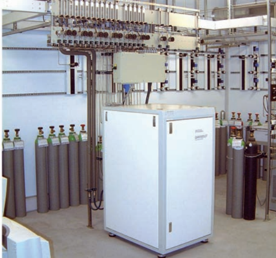
Spectromètre de masse pour l'analyse de pureté des gaz
