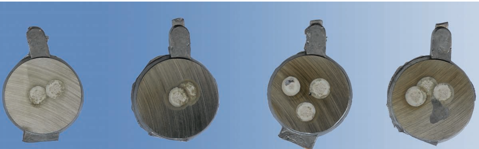
Spectrométrie d'absorption : tâches cathodiques sur échantillons métalliques
