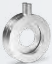
OPTIBAR OP 4100 Avec chambre annulaire et prises de pression dans les angles
