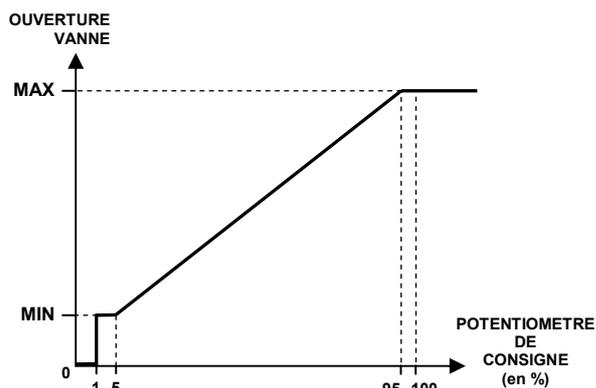
**Réglage de l'ouverture MIN :** Positionner le potentiomètre de face avant à 0 (butée lorsque que l'on tourne le potentiomètre dans le sens anti-horaire). Puis tourner le légèrement dans l'autre sens jusqu'à ce que la led clignote. Régler l'ouverture minimale avec le potentiomètre MIN de la face arrière.
