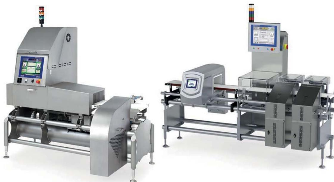
Système combiné de contrôle +/- avec détection des métaux ou détection par rayons X
